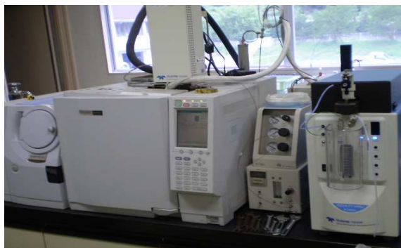
機器名 ページ&トラップ-GC-MS 測定物質 トリハロメタン 揮発性有機化合物
