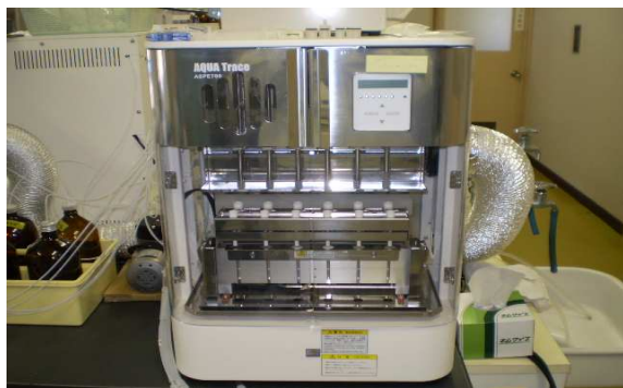
機器名 全自動固相抽出装置 測定物質 陰イオン界面活性剤 非イオン界面活性剤 フェノール類
