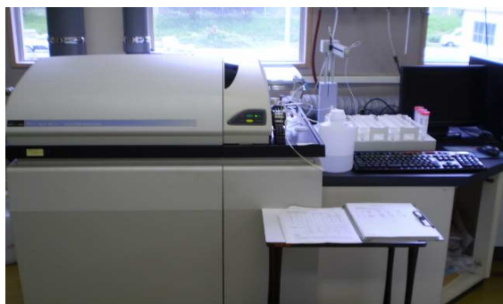
機器名 誘導結合プラズマ質量分析計 測定物質 カドミウム 鉄 マンガン
