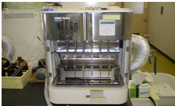
機器名 全自動固相抽出装置 測定物質 陰イオン界面活性剤 非イオン界面活性剤 フェノール類
