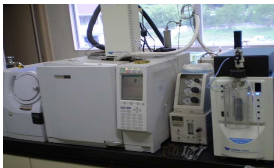
機器名 パージ&トラップ-GC-MS 測定物質 トリハロメタン 揮発性有機化合物
