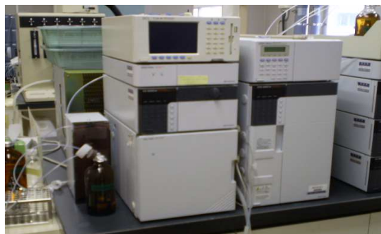
機器名 イオンクロマトグラフ 測定物質 硝酸態窒素及び亜硝酸態窒素 フッ素及びその化合物 塩化物イオン
