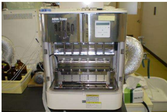
機器名 全自動固相抽出装置 測定物質 陰イオン界面活性剤 非イオン界面活性剤 フェノール類
