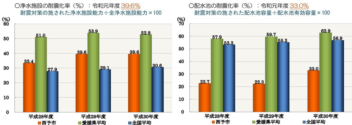
平成30年度における浄水施設の耐震化率は、39.6%となっており全国平均に比べ高い数値を示していますが、配水池の耐震化率は、全国平均及び愛媛県平均より大幅に低い数値となっています。なお、大規模な地震災害が発生した場合には、飲料水確保の観点から配水池を応急給水拠点として活用することが有効な手段であるため、配水池の耐震化と併せて緊急遮断弁の設置も検討していく必要があります。
