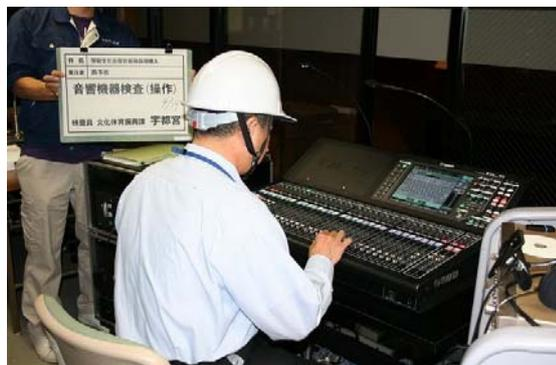
音響操作卓(デジタルミキサー) の操作検査
