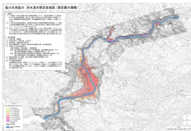
図 肱川水系肱川 洪水浸水想定区域図（想定最大規模）
